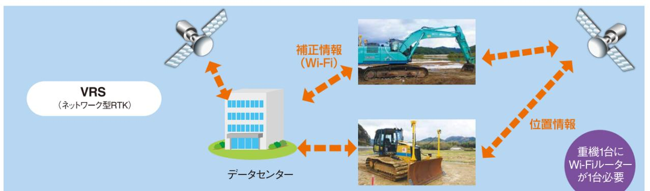
GNSS(Global Navigation Satellite System): 全球測位システム(そのうち、アメリカのものが「GPS」と、基準局(VRSは仮想基準点)で位置情報を確定する。
