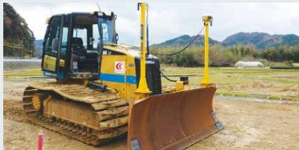
前後進するだけで、設計面に合わせてブレードが自動で上下し、敷均し作業!
