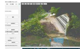
UAVによる空撮写真や、レーザスキャナ計測データを、ソフトウェアにより地形・地物などの3次元座標値を持つ点群データとして復元する。
