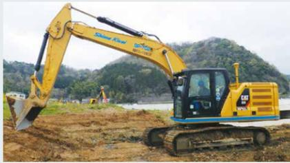
建設機械に搭載する三次元設計データと、GNSSやTSによる測位情報を元に、建設機械位置設計形状をコンピュータで求める。
