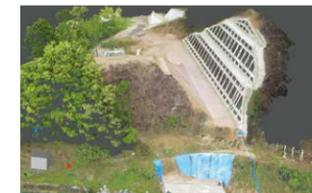
取得した点群データにある草木などの不要点(ノイズ)を点群処理ソフトウェアを用いて除去する。
